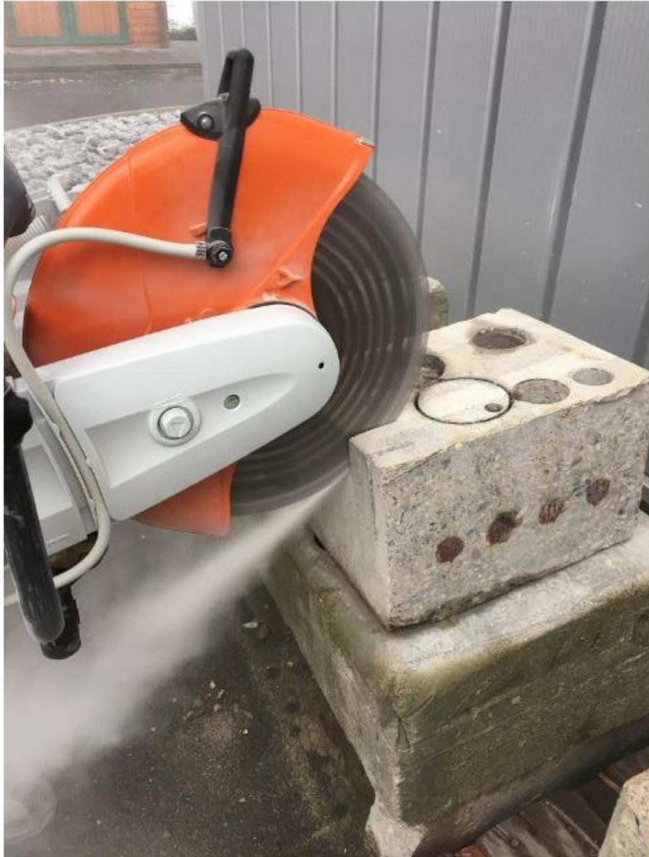
Trennschleifer für Stahlbeton
