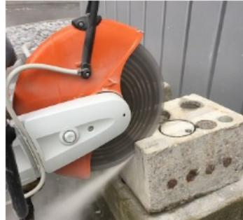
Trennschleifer für Stahlbeton
