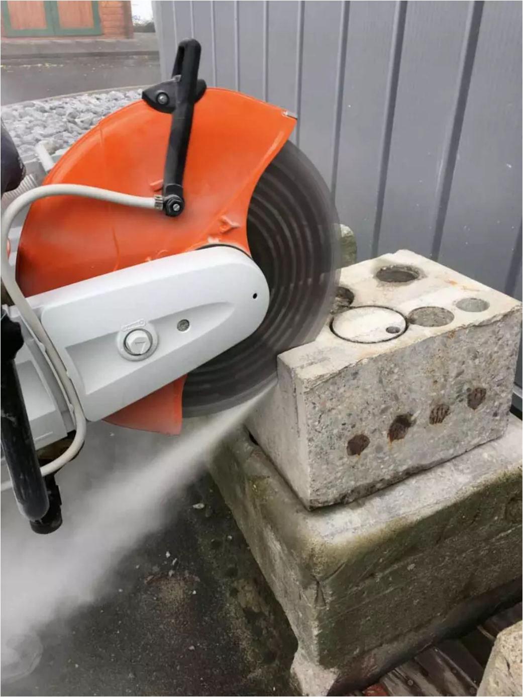
Ein Trennschleifer zum Sägen von Stahlbeton
